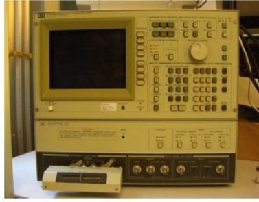
Figure 2.17 Impédancemètre HP4194A utilisé pour les mesures électriques
