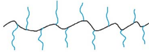
FIGURE 2.9 – Schéma d'un polymère réticulé.
