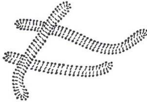
FIGURE 2.18 – Illustration d'un réseau de micelles géantes enchevêtrées [3]
