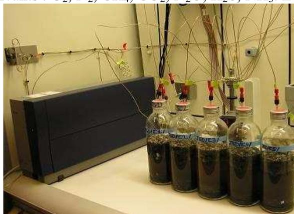
Figure 57 : Photographie du  $\mu$ GC et de son dispositif d'injection.
