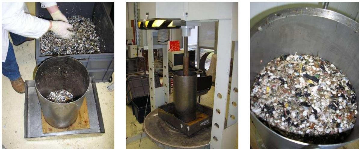
Figure 54 : Remplissage, compaction et introduction des déchets dans les pilotes.
