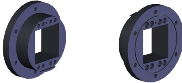
FIGURE 2.7 – Projet de réalisation de la bride d'adaptation du manchon expérimental.
