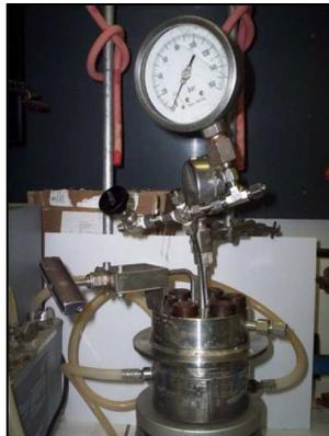
*Figure 20 : Autoclave utilisé pour la réaction de télomérisation.*
