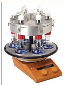
**Figure VI- 6 : Carrousel de réacteurs à agitation mécanique utilisé pour la synthèse de particules de polyuréthane.**
