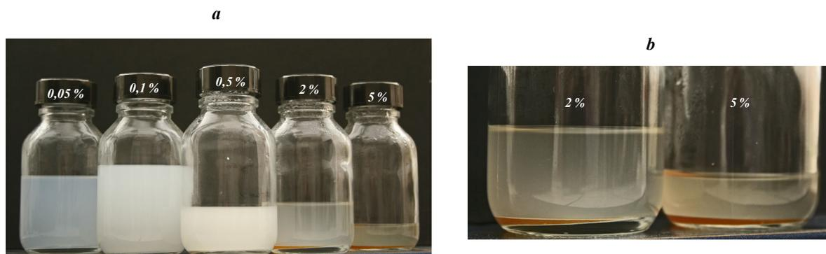
Figure III- 20 : a/ Echantillons des particules de polyuréthane issues (HO)C18-PEG<sub>600</sub>-C18(OH) porteur d'alcools primaires, à différentes concentrations dans l'eau. b/ Sédimentation des particules à 2% et 5% en masse dans l'eau.
