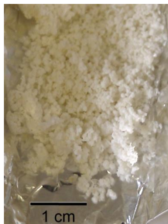
Figure V.17. Photographie d'un échantillon de polyéthylène préparé en présence de (Ind)_2ZrMe_2 comme catalyseur et [PI_{15-NMe_2H}]^+ [B(C_6F_5)_4]^- auto-assemblé à 0,1 mg/mL (essai 1).
