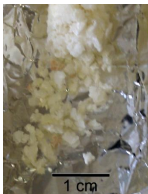
Figure V.18. Photographie d'un échantillon de polyéthylène préparé en présence de (\text{Ind})_2\text{ZrMe}_2 comme catalyseur et [\text{PI}_{15}\text{-NMe}_2\text{H}]^+ [\text{B}(\text{C}_6\text{F}_5)_4]^- auto-assemblé à 0,07 \text{ mg/mL} (essai 2).
