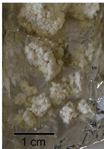
Figure V.15. Photographie d'un échantillon de polyéthylène préparé en présence de (Ind)_2ZrMe_2 comme catalyseur et [PhNMe_2H]^+ B[(C_6F_5)_4]^- comme activateur (Blanc 1).
