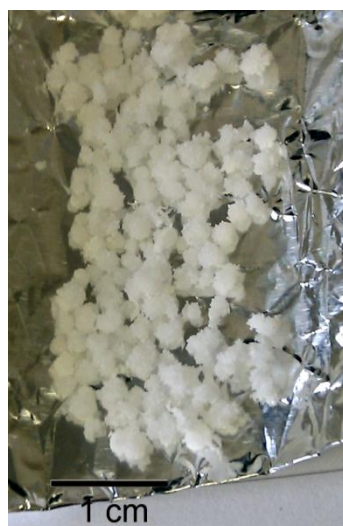
Figure V.21. Photographie d'un échantillon de polyéthylène préparé en présence de (\text{Ind})_2\text{ZrMe}_2 comme catalyseur et [PI_{29}\text{-NMe}_2\text{H}]^+ [\text{B}(\text{C}_6\text{F}_5)_4]^- auto-assemblé (essai 5).
