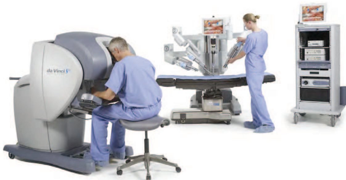
Figure 1 : Robot Da Vinci modèle S, ce modèle est remplacé par le modèle SI depuis début 2010 pour lequel les modifications les plus importantes interviennent sur la console chirurgien.
