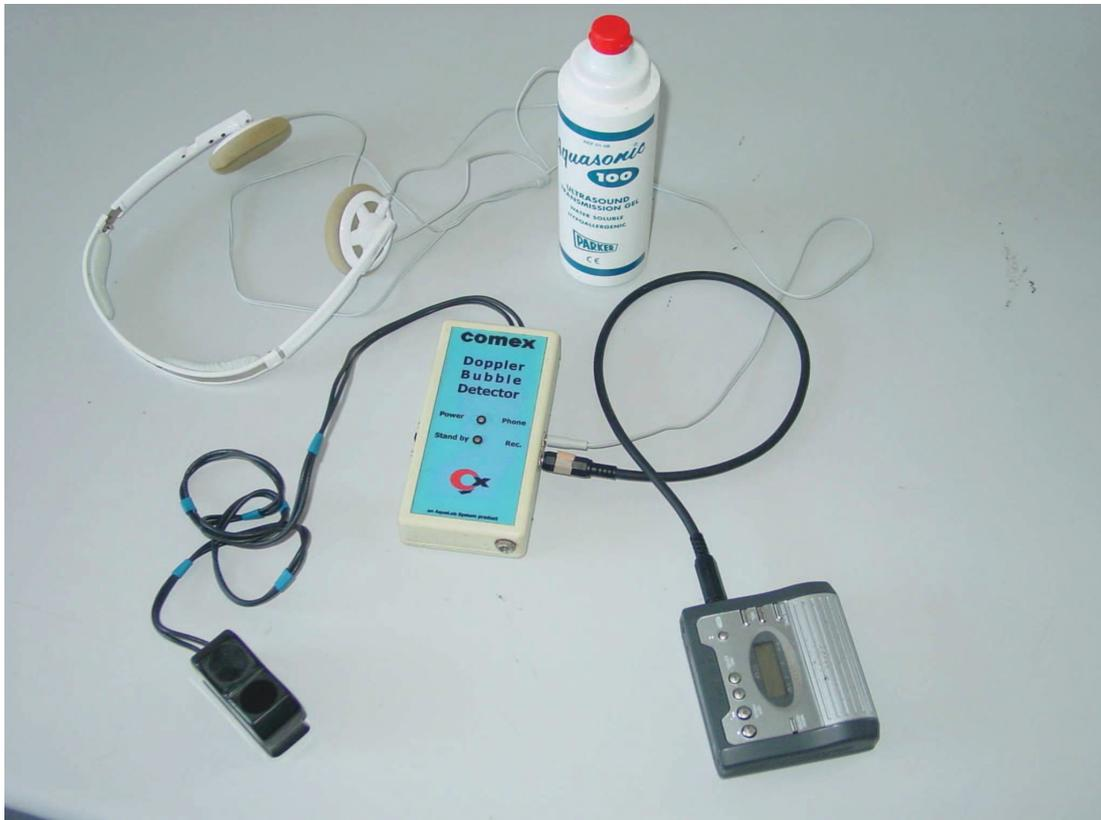
**Figure 49 – Système Doppler utilisé pour la détection de bulles au niveau précordial**
