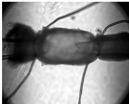
Figure 29 : artère intrapulmonaire de 3 ème ordre de rat montée sur les pipettes de verre de l'artériographe, et pressurisée à 10 mm Hg.
