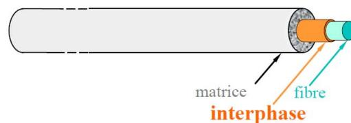
**Figure VI- 1 : Schéma d'un microcomposite [Rapaud, 2002]**
