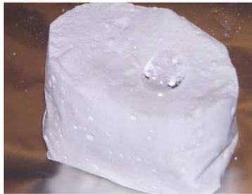
Figure 4.17 : Goutte d'eau déposée à la surface d'un ciment contenant OTES (pâte P6). L'angle de contact mesuré pendant les 60 premières secondes est de  $136^\circ$ .
