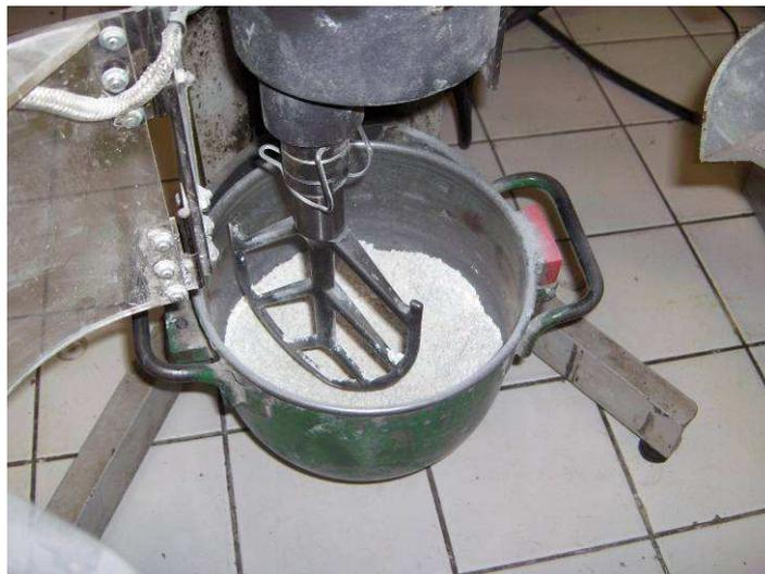
Figure 5.1 : Malaxeur Perrier utilisé pour la préparation des composites bois/ciment
