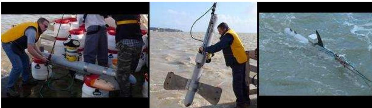
Figure 3 - 10 : Photos de l'ensemble ADP/flotteur et de sa mise à l'eau à partir du NO Côte de la Manche.
