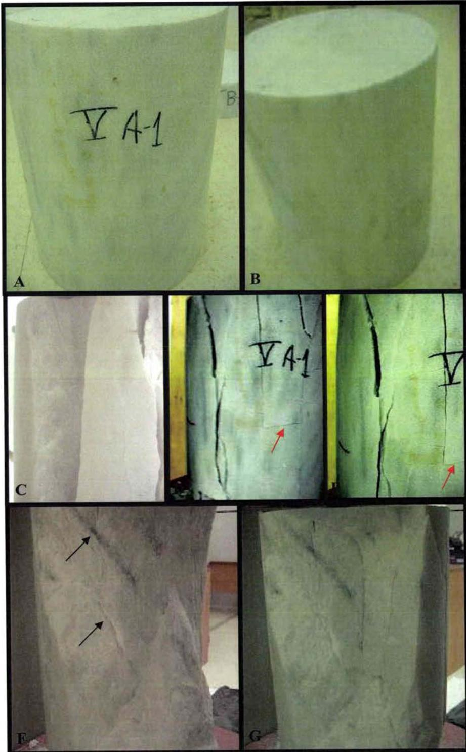
Figure 3.36 : Rupture en mode mixte de l'échantillon VA1.
