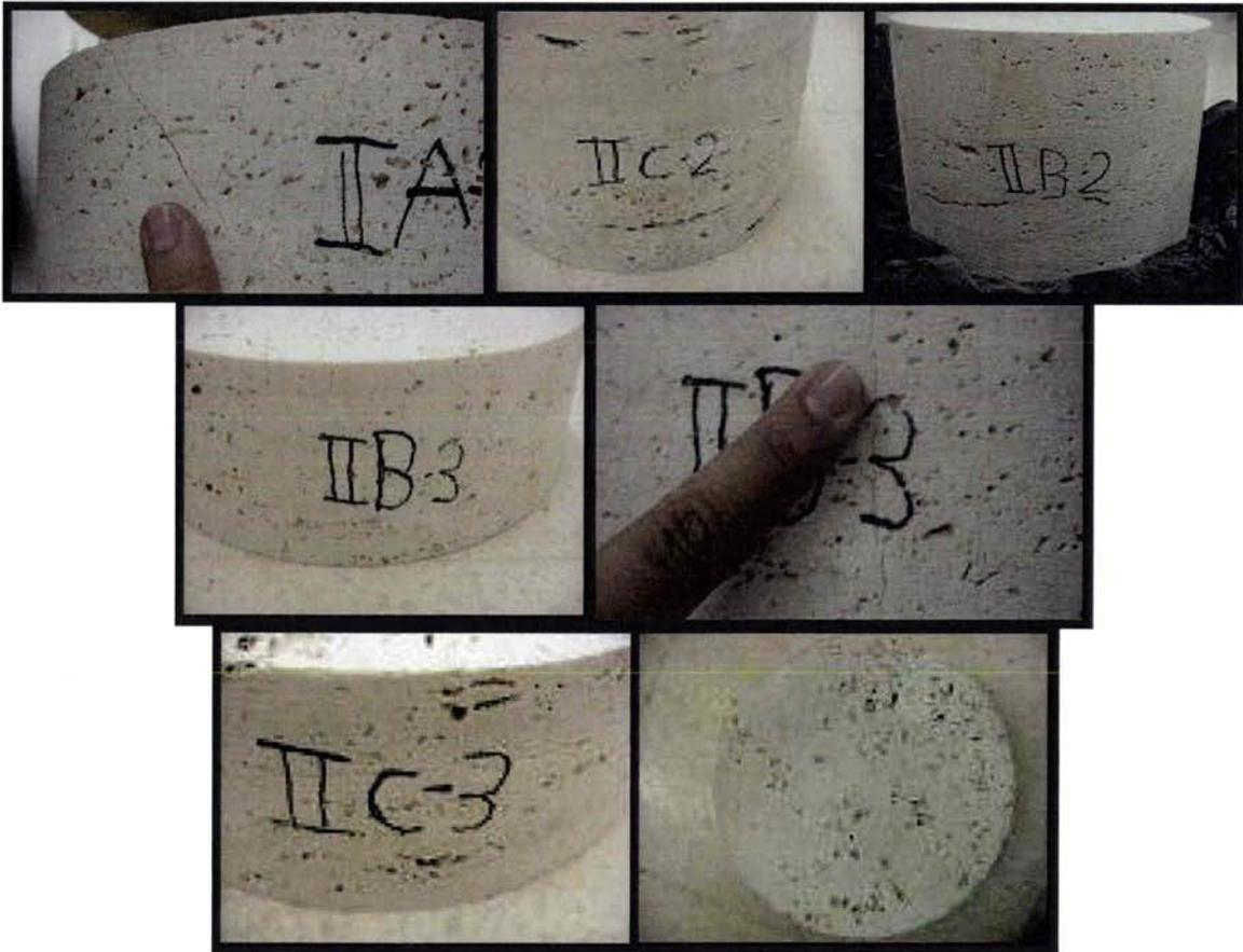
Figure 3.20 : Photos des échantillons avec élancement de 0,7 et 0,4.
