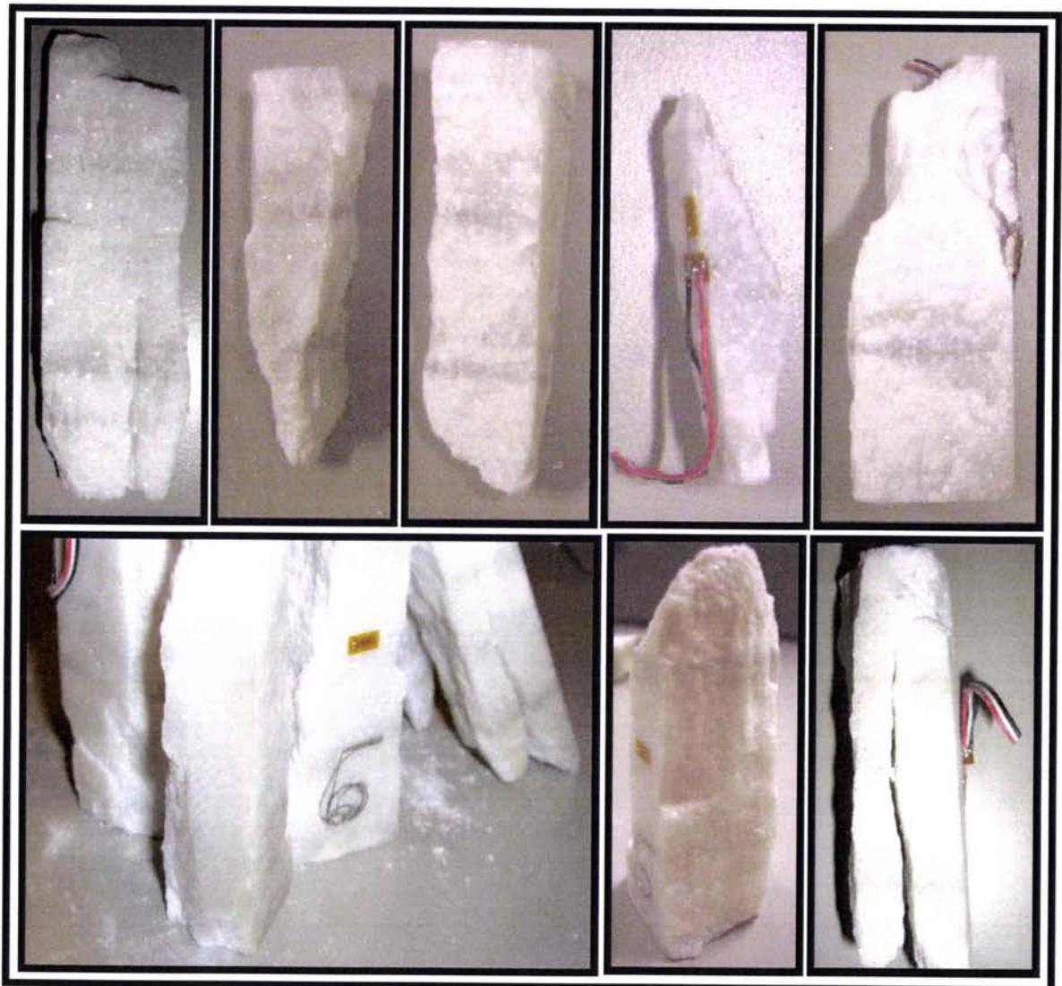
Figure 3.62 : Rupture en clivage axial de l'échantillon V3'aa.
