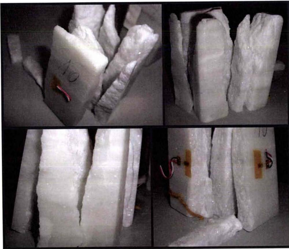
Figure 3.61 : Rupture en clivage axial de l'échantillon V3'as.
