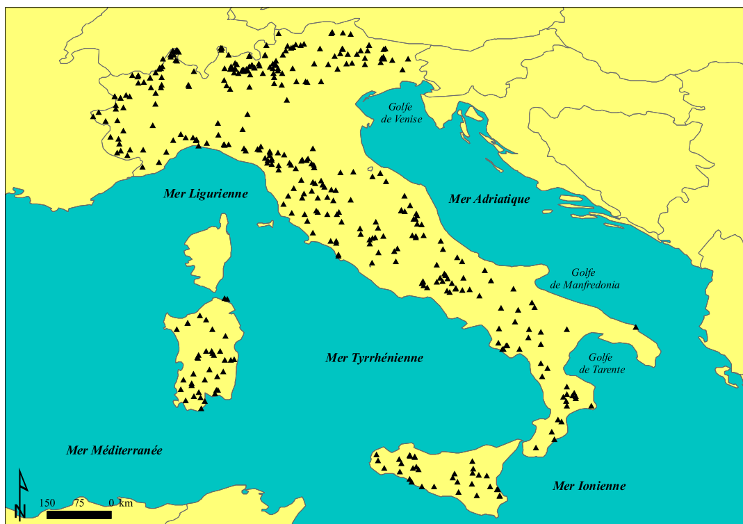
Figure 21 : Carte des grands barrages (▲) en Italie obtenue à partir d'une extraction de la base Eldred 2.08 au format DBF et d'une importation dans ArcView 9.2. (ESRI, 2004). Nombre : 415 ; hauteur moyenne (m) : 41 ; hauteur minimale (m) : 7 ; hauteur maximale (m) : 262.
